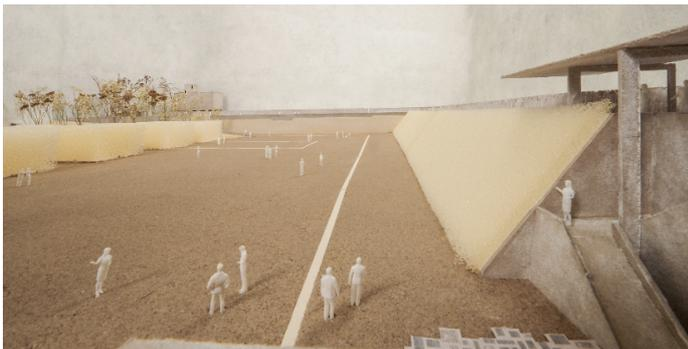
Der harte Apellplatz wird in der Verlängerung der Bestandsmauer durch eine steile begrünte Böschungsflanke gefasst. Eine bewehrte Böschungssicherung mit Stahlmatten sorgt dabei für die notwendige Stabilität. Gegenüber zeichnen Heckenkörper aus geschnittenen Birken die Dimension der Baracken und ihre Zwischenräume nach.
